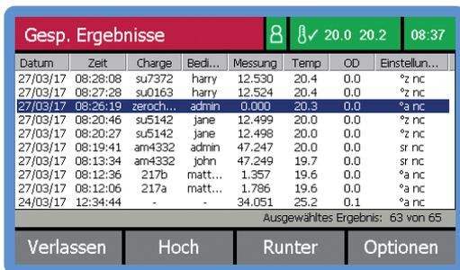
Kalibrierung und Konfiguration können mit einem Passwort geschützt werden, das über die Tastatur oder, aus Bequemlichkeitsgründen, einen vollständig konfigurierbaren RFID-Tag eingegeben werden kann. Dies, zusammen mit dem Protokoll, ermöglicht den Einsatz in Umgebungen, die den FDA-Vorschrift 21 CFR Teil 11 oder GLP konform sind. ADP400 Serie Polarimeter sind auch ideal zur Nutzung in Laboratorien geeignet, wo Konformität mit dem Arzneibuch erforderlich ist.
